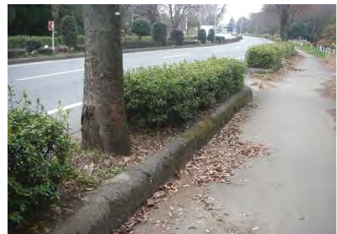
計画管理形状 側面剪定位置 ・道路側：縁石の前面から 25cm 内側 ・歩道側：縁石の内面
