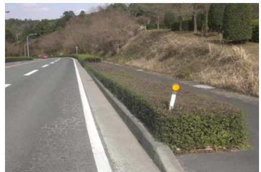
剪定高切下げ（視距確保の場合の例）
