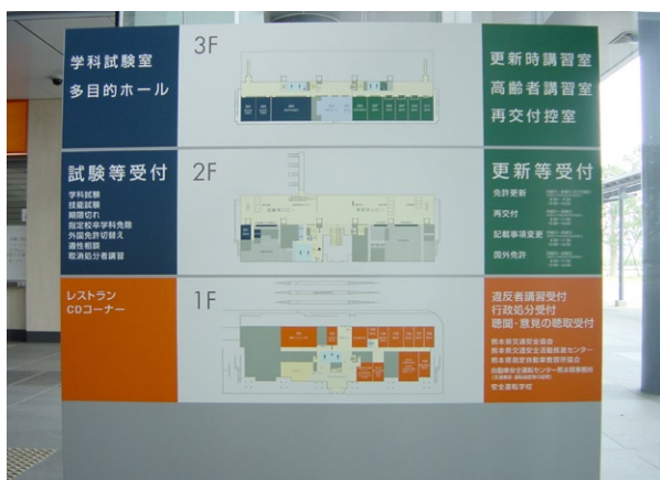
建物の利用目的によって色分けされた各階の案内サイン。文字情報だけでなく色で情報の認知が容易となります。
