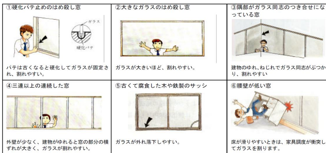
図 4.5.4 窓ガラスの地震対策の要点・危険性の高い窓（資料：一般財団法人日本建築防災協会）
