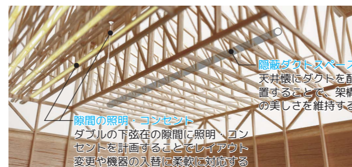
架構の美しさが保たれる設備配管スペースとコンセント・照明システム
