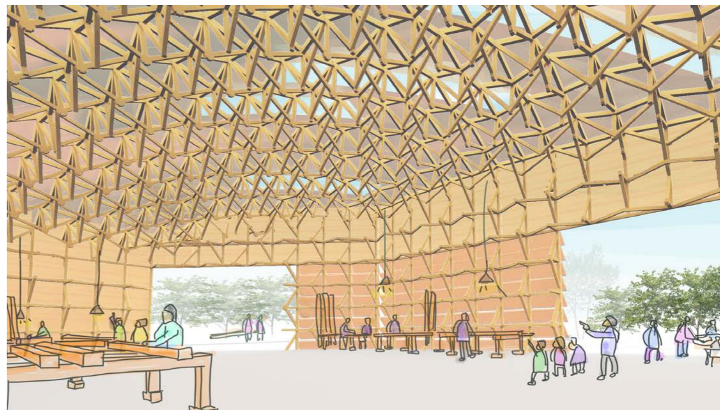
図5. 建物内観 搬入口(左側)と西側開口(右側)とそれらに挟まれた手動式ルバ-壁。上部には明り採りのハイライト。開放的な木造大空間。
